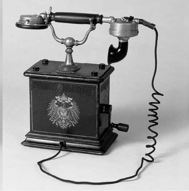
Fernsprechtischapparat „OB05“ von 1905. Das Telefon mit dem kaiserlichen Reichsadler gehörte in jede preußische Amtsstube. Ausgerüstet mit zwei Kurbeln, konnte es von beiden Seiten bedient werden.
