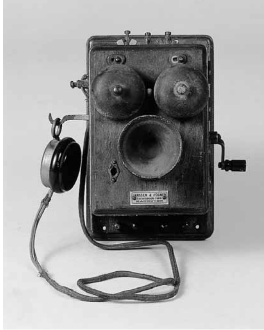
Wandtelefon aus Holz mit Kurbel aus dem Jahr 1905. Durch das Drehen der Handkurbel wurde im Postamt eine Meldeklappe betätigt. Gleich darauf meldete sich das „Fräulein vom Amt“ und stellte die Verbindung mit dem gewünschten Teilnehmer her.
