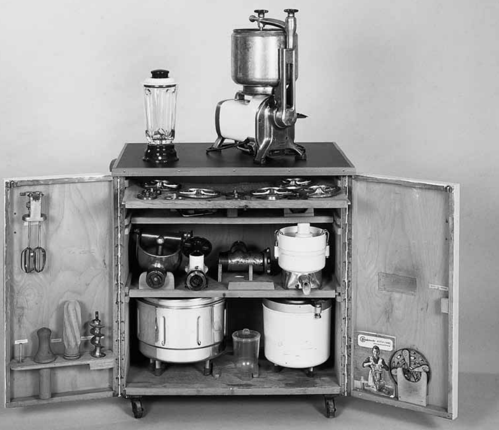
Allzweckküchenschrank „Allfix-zwei“ von Bauknecht um 1950. Der Schrank enthält einen Elektromotor und viele Aufsatzgeräte, unter anderem eine Kaffeemühle, ein Rührwerk, einen Fleischwolf, eine Vorrichtung um Bohnen zu schnippeln und einen Schneebesen.
