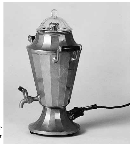
Elektrische Kaffeemaschine „Protos“ von Siemens um 1925. Die Kanne enthält ein Filtersieb für das Kaffeepulver, das nicht zu fein gemahlen werden durfte, damit das Sieb nicht verstopfte. Durch ein Steigrohr sprudelte das heiße Wasser über das Sieb.
