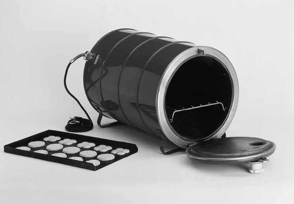
Die „Protos“-Brat- und Backröhre baute Siemens um 1927. Ein Gerät zum Braten, Backen, Schmoren, Warmhalten und Aufwärmen mit geringem Stromverbrauch. Die Brat- und Backröhre hatte zudem die Eigenschaft einer Kochkiste, in der auf 100 Grad erhitzte Speisen ohne weitere Wärmezufuhr weich kochten.
